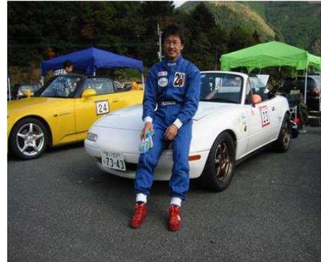
僕の手は1994年式ユーノスロードスターで、1800cc 4気筒NAエンジン140馬力、車重 約980kg タイヤ 185-60 R14~205-50 R15
